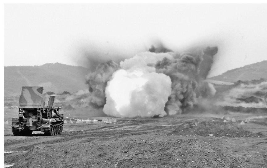
5月27日，陆军第72集团军某旅严格按照新大纲要求，组织官兵开展实战化训练。图为官兵扫雷车进行火箭爆破器开辟通路训练。
